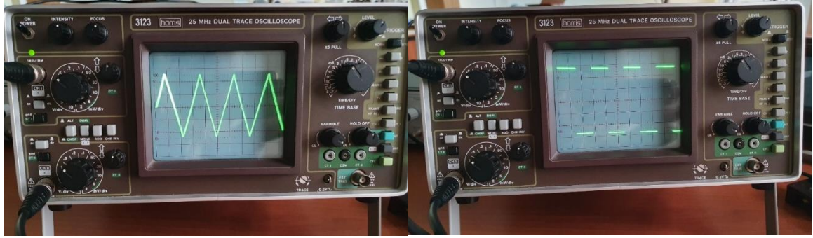
Şekil 9. Alternatif gerilimin osiloskop yardımı ile belirlenmesi için deney düzeneği
