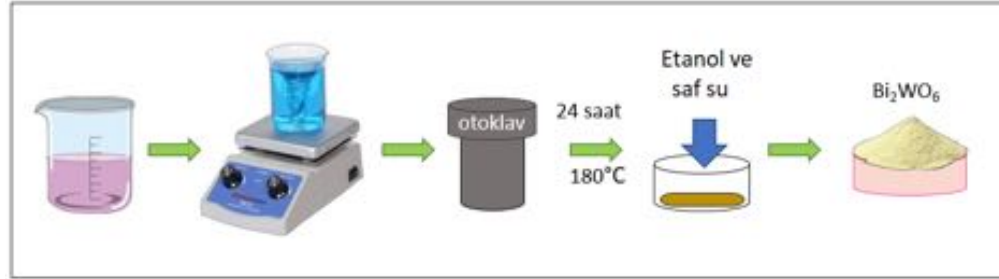
Şekil 1. Asitli \text{Bi}_2\text{WO}_6 'nin sentez süreci
